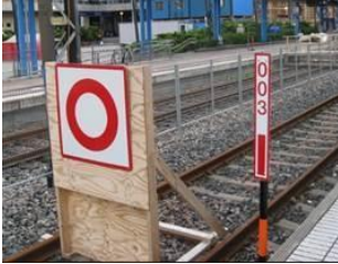
Kuva 2. SEIS-levy. Tätä merkkiä on käytettävä aina, kun rata suljetaan liikenteeltä ratatyön ajaksi.
